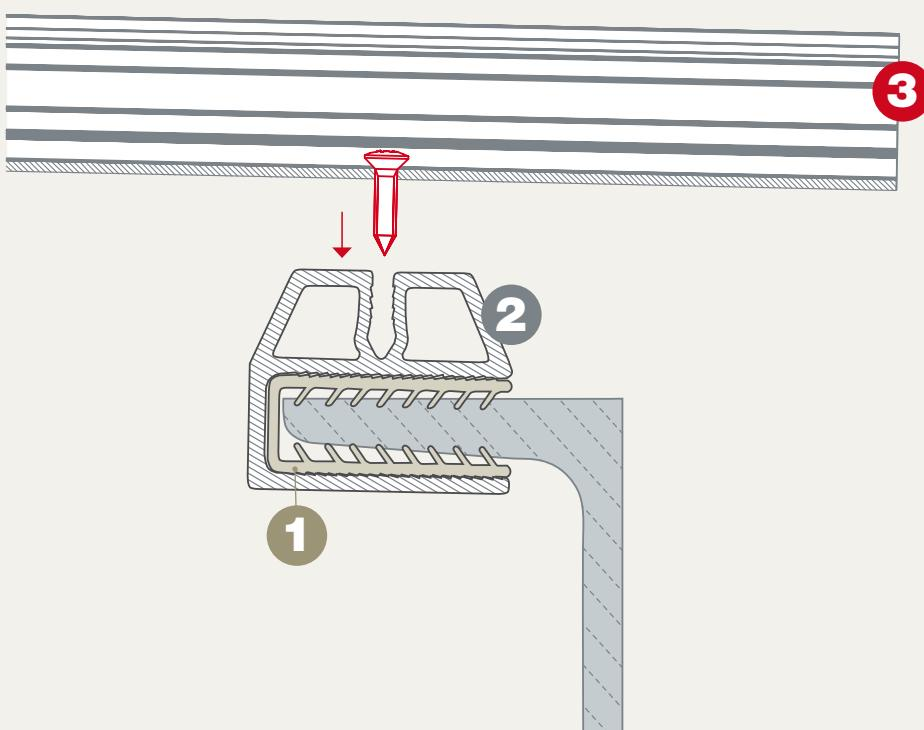
Gefällebildung durch unterschiedlich hohe Trägerprofile
